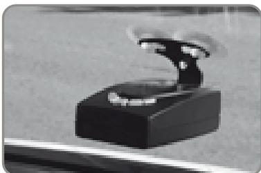
Dispositivo instalado correctamente. **Verifique su perfecta nivelación.** Una nivelación incorrecta disminuye drásticamente la distancia de aviso del detector.
