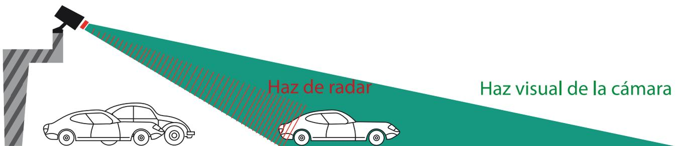
La condición de "haz" imposibilita por tanto que el radar pueda funcionar detrás de peraltes, esquinas u otros elementos opacos a las ondas de radio como metales. Si se trata de radares de pórtico, debe saber que estos dispositivos son capaces de distinguir el carril del vehículo que se está midiendo.
